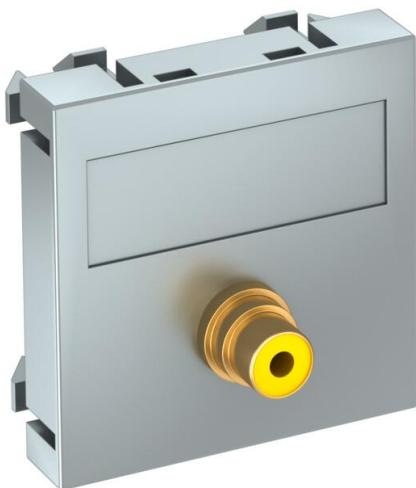
Suporte de multimédia com uma tomada de ligação RCA para sinal de vídeo composto, saída de cabo plana, com campo de inscrição, acoplamento RCA na versão tomada-tomada, codificação a cores em amarelo. Espelho com fixação por encaixe, adequado para a montagem horizontal e vertical em todo o sistema.
