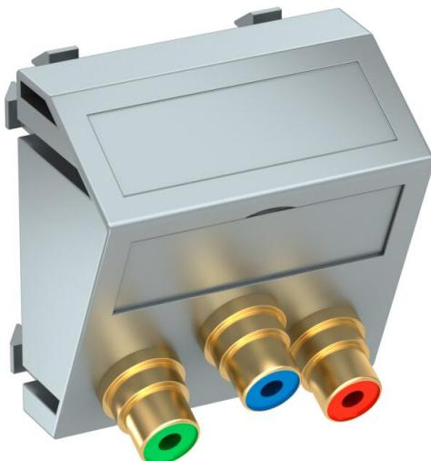
Suporte de multimédia com três tomadas de ligação RCA para Component Video, saída de cabo inclinada, com campo de inscrição, três acoplamentos RCA na versão tomada-tomada, codificação a cores em vermelho/verde/azul. Espelho com fixação por encaixe, adequado para a montagem horizontal e vertical em todo o sistema.
