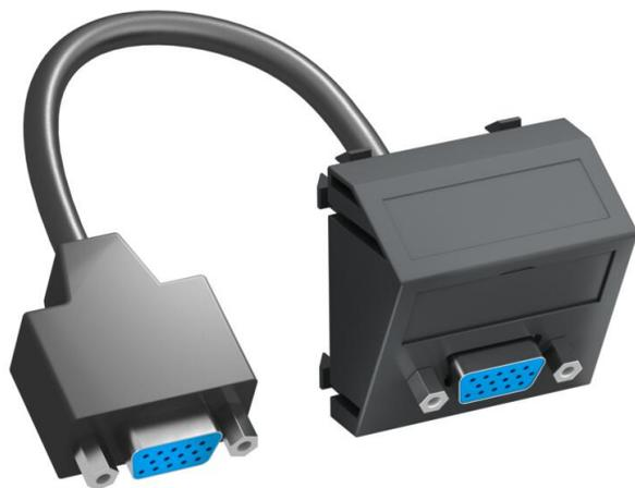
Suporte de multimédia com uma tomada de ligação VGA, saída de cabo inclinada, com campo de inscrição, cabo de ligação curto VGA (HD15) na versão tomada-tomada. Espelho com fixação por encaixe, adequado para a montagem horizontal e vertical em todo o sistema.
