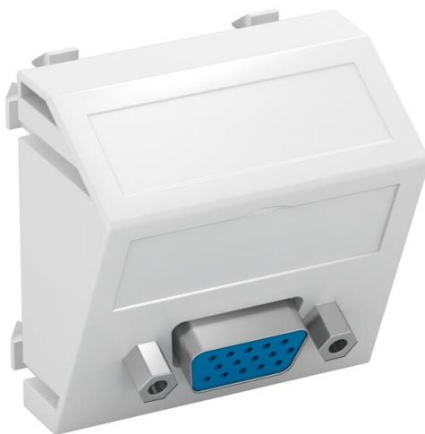
Suporte de multimédia com uma tomada de ligação VGA, saída de cabo inclinada, com campo de inscrição, tomada VGA (HD15) com conexão de rosca. Espehlo com fixação por encaixe, adequado para a montagem horizontal e vertical em todo o sistema.
