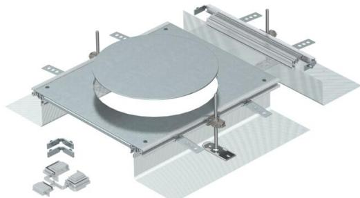
Unidade de ampliação da calha, fornecida com abertura na tampa para a instalação de uma tampa de encastramento do tipo GESR9, constituída por perfis laterais em malha flexível metálica, perfis de instalação do pavimento, tampa da calha equipada com tampa de obra e um topo. O material fornecido inclui 3 esquadros de fixação com nivelamento de altura, 3 escora estabilizadora, 1 suporte de tampa (sem niveladores - por favor encomendar em separado) e 1 kit de montagem de ângulo.
