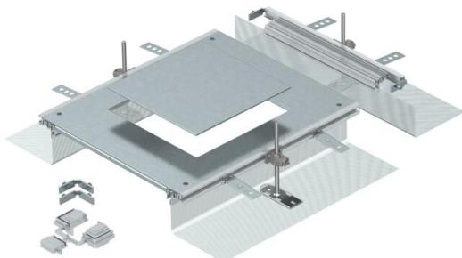
Unidade de ampliação da calha, fornecida com abertura na tampa para a instalação de uma tampa de encastramento do tipo GES9, constituída por perfis laterais em malha flexível metálica, perfis de instalação do pavimento, tampa da calha equipada com tampa de obra e um topo. O material fornecido inclui 3 esquadros de fixação com nivelamento de altura, 3 escora estabilizadora, 1 suporte de tampa (sem niveladores - por favor encomendar em separado) e 1 kit de montagem de ângulo.
