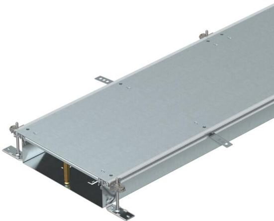
Calha para a condução de cabos, com 3 tampas com mola, constituída por base e laterais em chapa. Base inferior do pavimento com entalhes para a montagem por encaixe dos separadores. O material fornecido inclui 6 esquadros de fixação com nivelamento de altura, 6 escoras estabilizadoras 6 escoras estabilizadoras e tampas 3 unid. em calhas de 200, 300 e de 400 e 6 unid. em calhas de 500 e 600. Calha fornecida com a tampa de mola montada
