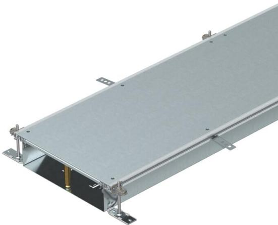
Calha para condução de cabos com 3 tampas cegas, constituída por base e laterais em chapa. Base inferior do pavimento com entalhes para a montagem por encaixe dos separadores. O material fornecido inclui 6 esquadros de fixação com nivelamento de altura, 6 escoras estabilizadoras e tampas 3 unid. em calhas de 200, 300 e de 400 e 6 unid. em calhas de 500 e 600. Calha fornecida com a tampa da calha aparafusada.
