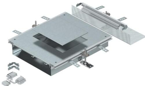
Calha, fornecida com abertura na tampa para a instalação de uma tampa de encastramento do tipo GES6, constituída com base e laterais em chapa, perfis de instalação do pavimento, tampa da calha equipada com tampa de obra e um topo. O material fornecido inclui 3 esquadros de fixação com nivelamento de altura, 3 escora estabilizadora, 1 suporte de tampa e 1 kit de montagem de ângulo. Tamanho da abertura de montagem adequado para a instalação de uma tampa retangular de tamanho 6.
