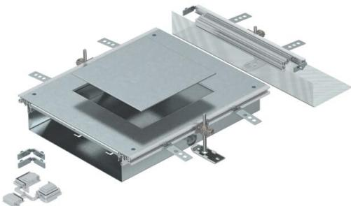
Unidade de ampliação da calha, fornecida com abertura na tampa para a instalação de uma tampa de encastramento do tipo GES9, constituída com base e laterais em chapa, perfis de instalação do pavimento, tampa da calha equipada com tampa de obra e um topo. O material fornecido inclui 3 esquadros de fixação com nivelamento de altura, 3 escora estabilizadora, 1 suporte de tampa e 1 kit de montagem de ângulo.
