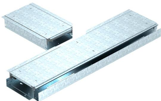
Derivação pronta a instalar, constituída por base, duas tampas, perfis laterais ajustáveis em altura. O material fornecido inclui duas vedações de impacto da tampa e duas uniões. Para ajuste em altura, são necessários seis níveladores.
