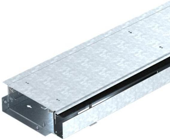
Calhas para a condução de cabos e instalação de aparelhagens, constituída por uma base de calha, duas tampas e uma escova protetora regulável em altura. O material fornecido inclui duas vedações de impacto da tampa e uma união. Para ajuste em altura, são necessários seis niveladores. Capacidade de carga até, no máx., 5 kN. A unidade de calhas pode ser complementada com um perfil de instalação do pavimento para separação de betonilha no âmbito de intradorsos de porta e nichos de radiadores.
