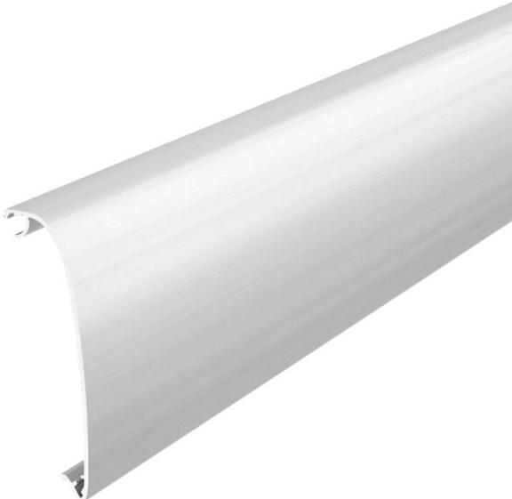
Tampa para criação de uma calha técnica com design da série GAD. Versão de design "Soft" para cobertura total da abertura do sistema e dos aparelhos de ligação e distribuição. Os adaptadores de tampa GAD OTA são obrigatórios e devem ser projetados com uma distância máx. de 50 cm no percurso da calha. Deve ser colocado um distanciador GAD OTD entre as tampas.
