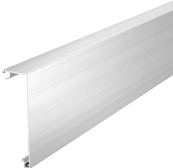
Tampa para criação de uma calha técnica com design da série GAD. Versão de design "Style" para cobertura total da abertura do sistema e dos aparelhos de ligação e distribuição. Os adaptadores de tampa GAD OTA são obrigatórios e devem ser projetados com uma distância máx. de 50 cm no percurso da calha. Deve ser colocado um distanciador GAD OTD entre as tampas.
