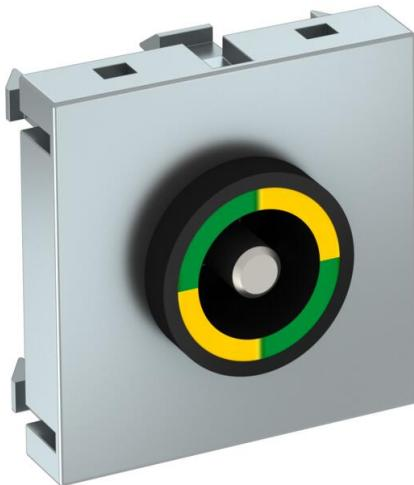
Tomada de compensação de potencial conforme a DIN 42801, tomada preta com anel verde-amarelo, ligação de cabos traseira com pernos roscados M6, incluindo duas porca, arruelas de porca e uma anilha recartilhada.
