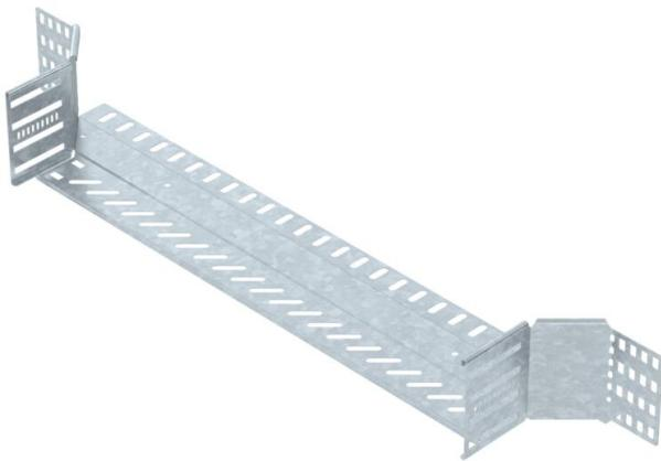
Derivação simples para a criação de um ramal ou cruzeta horizontal, para caminhos de cabos em chapa de encaixe e de aparafusar, altura lateral de 110 mm. Montagem sem parafusos com grampos duplos ou ligação roscada com parafusos de cabeça boleada FRS e porcas combinadas M6. Indicado para áreas interiores e exteriores. O material de fixação terá que ser encomendado em separado.
