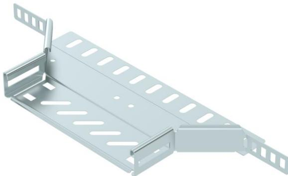
Derivação simples para a criação de um ramal ou cruzeta horizontal, para caminhos de cabos em chapa de encaixe e de aparafusar, altura lateral de 35 mm. Ligação rosada com parafusos de cabeça boleada FRS e porcas combinadas M6. Aplicável em áreas interiores. O material de fixação terá que ser encomendado em separado.
