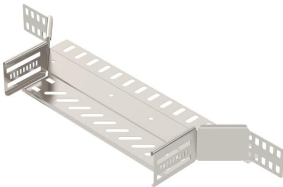
Derivação simples para a criação de um ramal ou cruzeta horizontal, para caminhos de cabos em chapa de encaixe e de aparafusar, altura lateral de 60 mm. Montagem sem parafusos com grampos duplos ou ligação rosada com parafusos de cabeça boleada FRS e porcas combinadas M6. Indicado para áreas interiores e exteriores. O material de fixação terá que ser encomendado em separado.
