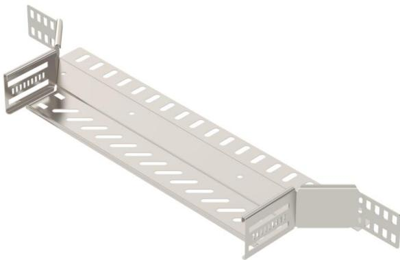
Derivação simples para a criação de um ramal ou cruzeta horizontal, para caminhos de cabos em chapa de encaixe e de aparafusar, altura lateral de 60 mm. Montagem sem parafusos com grampos duplos ou ligação rosada com parafusos de cabeça boleada FRS e porcas combinadas M6. Indicado para áreas interiores e exteriores. O material de fixação terá que ser encomendado em separado.
