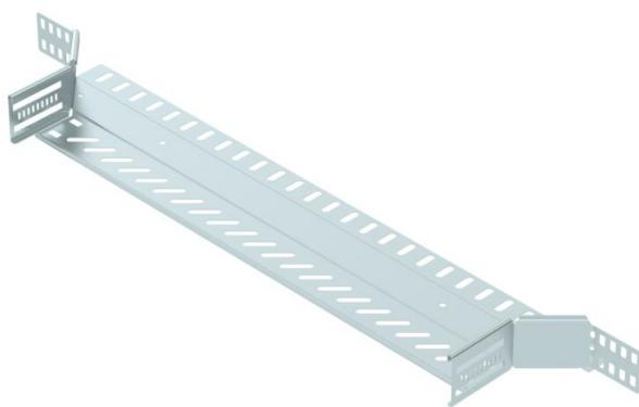
Derivação simples para a criação de um ramal ou cruzeta horizontal, para caminhos de cabos em chapa de encaixe e de aparafusar, altura lateral de 60 mm. Montagem sem parafusos com grampos duplos ou ligação rosada com parafusos de cabeça boleada FRS e porcas combinadas M6. Aplicável em áreas interiores. O material de fixação terá que ser encomendado em separado.
