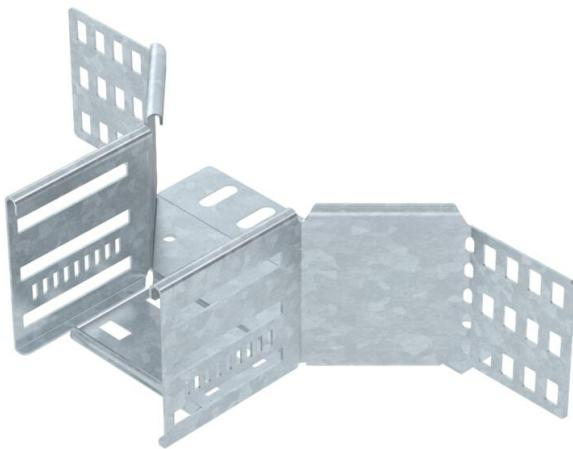
Derivação simples para a criação de um ramal ou cruzeta horizontal, para caminhos de cabos em chapa de encaixe e de aparafusar, altura lateral de 85 mm. Montagem sem parafusos com grampos duplos ou ligação rosada com parafusos de cabeça boleada FRS e porcas combinadas M6. Indicado para áreas interiores e exteriores. O material de fixação terá que ser encomendado em separado.
