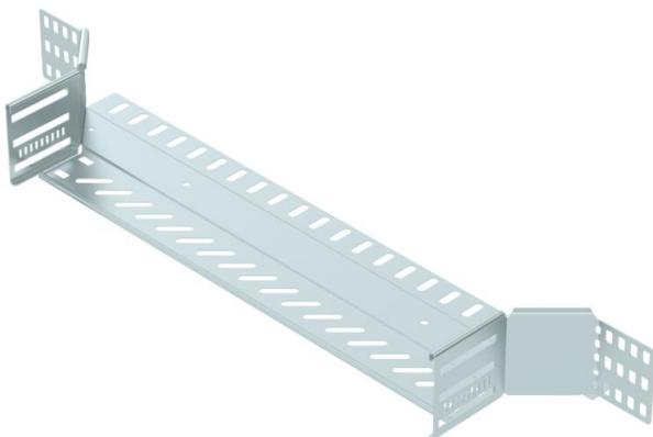
Derivação simples para a criação de um ramal ou cruzeta horizontal, para caminhos de cabos em chapa de encaixe e de aparafusar, altura lateral de 85 mm. Montagem sem parafusos com grampos duplos ou ligação rosada com parafusos de cabeça boleada FRS e porcas combinadas M6. Aplicável em áreas interiores. O material de fixação terá que ser encomendado em separado.
