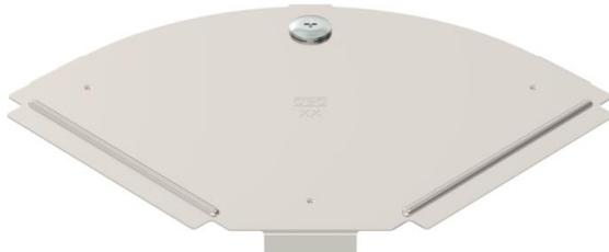
Tampa para ângulo de 45° para caminhos de cabos em chapa de encaixe e de aparafusar em áreas interiores e exteriores, para proteger os cabos contra danos e sujidade. Fixação com ferrolho pré-montado e por apoio da tampa na secção. Adequada para todas as alturas laterais. A tampa pode ser aplicada em peças de todas as alturas laterais.
