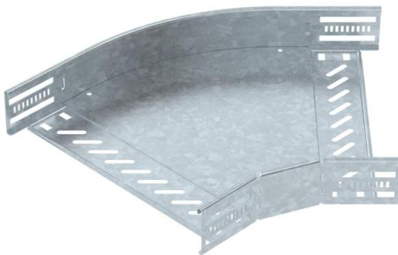
Ângulo de 45° para a criação de um ramal horizontal, para caminhos de cabos em chapa de encaixe e de aparafusar, altura lateral de 60 mm. Montagem sem parafusos com grampos duplos ou ligação rosada com parafusos de cabeça boleada FRS e porcas combinadas M6. Indicado para áreas interiores e exteriores. O material de fixação terá que ser encomendado em separado.
