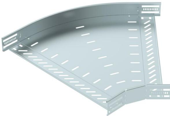
Ângulo de 45° para a criação de um ramal horizontal, para caminhos de cabos em chapa de encaixe e de aparafusar, altura lateral de 60 mm. Montagem sem parafusos com grampos duplos ou ligação rosada com parafusos de cabeça boleada FRS e porcas combinadas M6. Aplicável em áreas interiores. O material de fixação terá que ser encomendado em separado.
