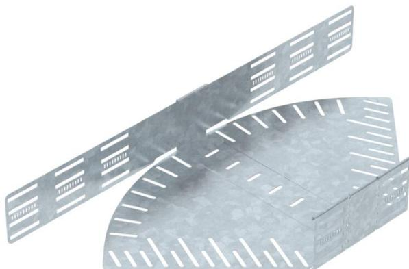
Ângulo ajustável para a criação de um ramal horizontal, para caminhos de cabos em chapa de encaixe e de aparafusar, altura lateral de 110 mm. Ângulo ajustável de 0 - 90°. Montagem sem parafusos com grampos duplos ou ligação rosada com parafusos de cabeça boleada FRS e porcas combinadas M6. Aplicável em áreas interiores e exteriores. O material de fixação terá que ser encomendado em separado.
