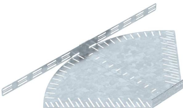
Ângulo ajustável para a criação de um ramal horizontal, para caminhos de cabos em chapa de encaixe e de aparafusar, altura lateral de 60 mm. Ângulo ajustável de 0 - 90°. Montagem sem parafusos com grampos duplos ou ligação rosada com parafusos de cabeça boleada FRS e porcas combinadas M6. Aplicável em áreas interiores e exteriores. O material de fixação terá que ser encomendado em separado.
