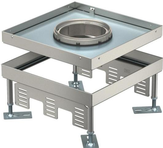
Tampa quadrada nivelável de grandes cargas para tubo periscópio de tamanho 9, para a montagem de aparelhos de instalação em sistemas de calhas e chão falso, em pavimentos de limpeza a seco ou a húmido em interiores. Classe de carga 1 a 10 kN.
