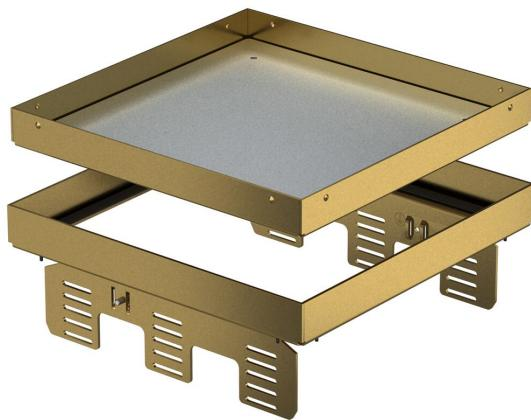
Tampa "cega" nivelável e desacoplada do piso para criar uma abertura de inspeção de tamanho nominal 9 em pavimentos tratados a seco ou húmido em interiores, para a montagem em caixas de pavimento UZD250-3 ou UZD350-3, em cada caso em conjunto com um aro de redução DUG..9 ou em UGD250-3/9 ou UGD350-3/9. A montagem é efetuada através de niveladores (encomendar separadamente) no perfil da estrutura de alumínio das caixas de pavimento. Apenas adequada para pavimentos lisos.
