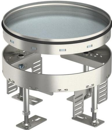
Tampa redonda "cega" para grandes cargas no tamanho nominal R4, para a criação de uma abertura de inspeção em sistemas de calhas de pavimento e chão falso, em pavimentos tratados a seco ou a húmido em interiores. Classe de carga 2 a 20 kN. Apenas adequada para pavimentos lisos.
