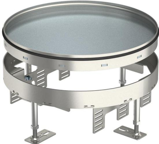
Tampa redonda "cega" para grandes cargas no tamanho nominal R9, para a criação de uma abertura de inspeção em sistemas de calhas de pavimento e chão falso, em pavimentos tratados a seco ou a húmido em interiores. Classe de carga 2 a 20 kN. Apenas adequada para pavimentos lisos.
