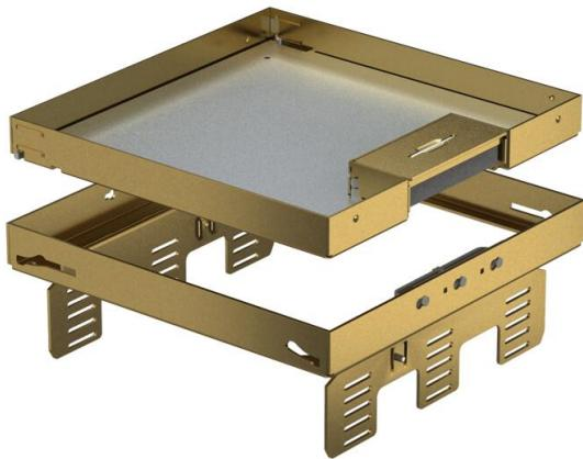
Tampa nivelável e desacoplada do pavimento de tamanho nominal 9, com saída de cabos, para a montagem de aparelhos de instalação em pavimentos tratados a seco em interiores, para montagem em caixas de pavimento UZD250 ou UZD350, em cada caso em conjunto com um aro de redução DUG../9 ou em UGD250-3/9 ou UGD350-3/9. A montagem é efetuada através de niveladores (encomendar separadamente) no perfil da estrutura de alumínio das caixas de pavimento.
