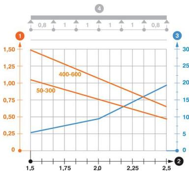
Diagrama de cargas do caminho de cabos em chapa RKS 60 não acanalado
