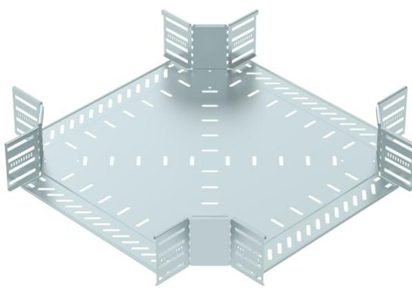
Cruzeta para a criação de um ramal horizontal, para caminhos de cabos em chapa de encaixe e de aparafusar, altura lateral de 110 mm. Montagem sem parafusos com grampos duplos ou ligação rosada com parafusos de cabeça boleada FRS e porcas combinadas M6. Aplicável em áreas interiores. O material de fixação terá que ser encomendado em separado.
