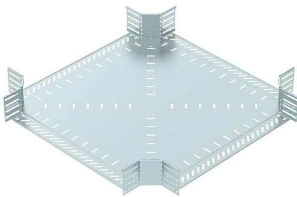
Cruzeta para a criação de um ramal horizontal, para caminhos de cabos em chapa de encaixe e de aparafusar, altura lateral de 110 mm. Montagem sem parafusos com grampos duplos ou ligação rosada com parafusos de cabeça boleada FRS e porcas combinadas M6. Aplicável em áreas interiores. O material de fixação terá que ser encomendado em separado.
