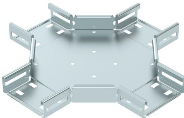
Cruzeta para a criação de um ramal horizontal, para caminhos de cabos em chapa de encaixe e de aparafusar, altura lateral de 35 mm. Ligação roscada com parafusos de cabeça boleada FRS e porcas combinadas M6. Aplicável em áreas interiores. O material de fixação terá que ser encomendado em separado.
