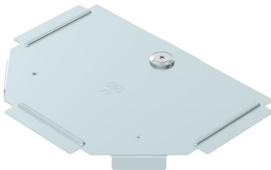
Tampa para derivação em T para caminhos de cabos em chapa de encaixe e de aparafusar em áreas interiores e exteriores, para proteger os cabos contra danos e sujidade. Fixação com ferrolho pré-montado e por apoio da tampa na secção. Adequada para todas as alturas laterais.
