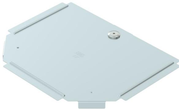
Tampa para derivação em T para caminhos de cabos em chapa de encaixe e de aparafusar em áreas interiores e exteriores, para proteger os cabos contra danos e sujidade. Fixação com ferrolho pré-montado e por apoio da tampa na secção. Adequada para todas as alturas laterais. A tampa pode ser aplicada em peças de todas as alturas laterais.
