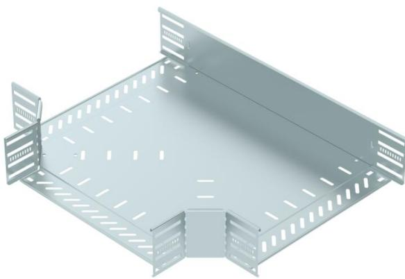
Derivação em T para a criação de um ramal horizontal, para caminhos de cabos em chapa de encaixe e de aparafusar, altura lateral de 110 mm. Montagem sem parafusos com grampos duplos ou ligação rosada com parafusos de cabeça boleada FRS e porcas combinadas M6. Aplicável em áreas interiores. O material de fixação terá que ser encomendado em separado.
