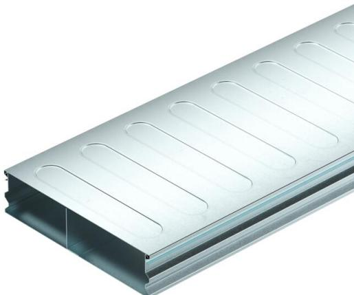
Calha de pavimento (2 peças) para colocação dos cabos e fios em sistemas de pavimentos cobertos de betonilha, de acordo com a norma EN 50085-2-2. Base e tampa da calha contínua. Com separador na base da calha. Capacidade de carga máxima até 1,5kN. Compatível apenas com o UZD250-4/350-4. As paredes laterais perfiladas proporcionam uma função de encaixe para encaixar a tampa da calha na base. O reforço das esferas na tampa da calha servem para a estabilização.
