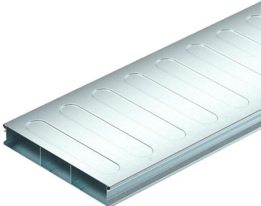
Calha de pavimento (2 peças) para colocação dos cabos e fios em sistemas de pavimentos cobertos de betonilha, de acordo com a norma EN 50085-2-2. Base e tampa da calha contínua. Com separador na base da calha. Capacidade de carga máxima até 1,5kN.
