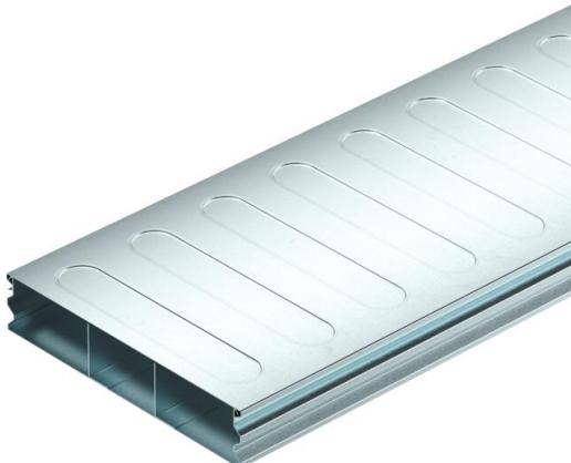
Calha de pavimento (2 peças) para colocação dos cabos e fios em sistemas de pavimentos cobertos de betonilha, de acordo com a norma EN 50085-2-2. Base e tampa da calha contínua. Com separador na base da calha. Capacidade de carga máxima até 1,5kN.
