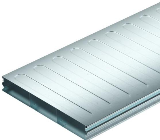
Calha de pavimento (2 peças) para colocação dos cabos e fios em sistemas de pavimentos cobertos de betonilha, de acordo com a norma EN 50085-2-2. Base e tampa da calha contínua. Com separador na base da calha. Capacidade de carga máxima até 1,5kN.
