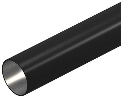
Tubo de instalação elétrica sem pontas roscadas conforme EN 61386-1, para a proteção mecânica de cabos e condutores. Com parede interior sem rebarbas. Classe de proteção contra corrosão 2 (média).
