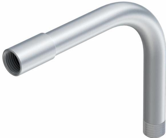
Ângulo de 90° para tubos de instalação elétrica conforme a EN 61386-1 com pontas rosadas de acordo com DIN EN 60423. Parede interior sem rebarbas. Cada ângulo de tubo já inclui uma união instalada.
