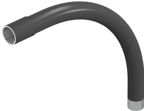
Ângulo de 90° para tubos de instalação elétrica conforme a EN 61386-1 com pontas roscadas de acordo com DIN EN 60423. Parede interior sem rebarbas. Cada ângulo de tubo já inclui uma união instalada.
