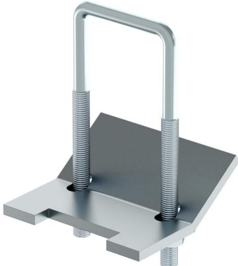
Elemento de conexão para a fixação em ambos os lados de perfis em vigas de aço. A fixação é possível independentemente da disposição da abertura do perfil. O comprimento do perfil deve ter pelo menos a largura da viga de aço + 2 x 50 mm.
