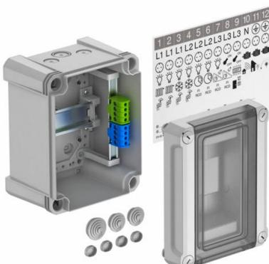
Quadro de distribuição com régua de bornes para montagem à superfície, para sub-distribuição de energia em área interior e área exterior protegida, de acordo com a IEC 439-3. Com calha DIN de 35 mm pré-montada. Classe de proteção IP66 e grau de proteção IK07. Tampa transparente para aparafusar, com recorte.
