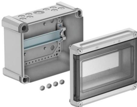
Quadro de distribuição para montagem à superfície, para sub-distribuição de energia em área interior e área exterior protegida, de acordo com a IEC 439-3. Com calha DIN de 35 mm pré-montada. Classe de proteção IP66 e grau de proteção IK07. Tampa transparente para aparafusar, com recorte.
