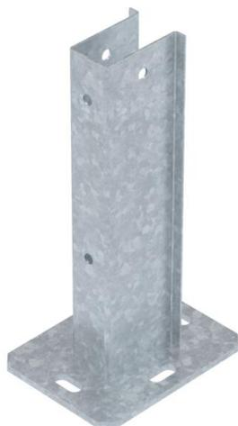
Pé de apoio como retenção para estruturas pré-montadas para a montagem de sistemas fotovoltaicos em espaço aberto. Montagem em fundações de betão com parafusos de ancoragem M16. O material de fixação terá que ser encomendado em separado.
